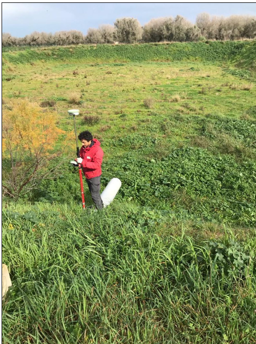
Foto 5. Area vasche di spandimento: quota tubazione di arrivo e fondo vasca.
